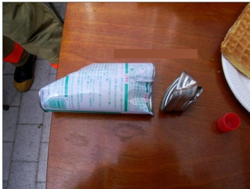
写真2：破裂したカセットボンベ
